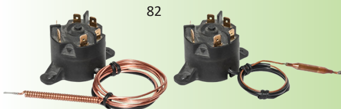
82 Трехполюсный термостат высокого предела с ручным сбросом, отказоустойчивый, фиксированная настройка, диапазон температур до 170°C
