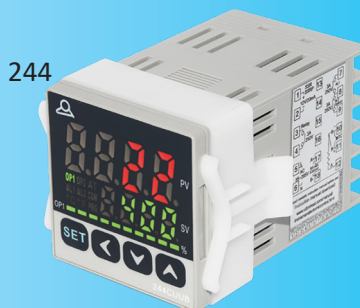
244 48 x 48 мм электронный контроллер с двойным дисплеем, ВКЛ-ВЫКЛ и PID автонстрайка, несколько датчиков, релейные и SSR выходы
